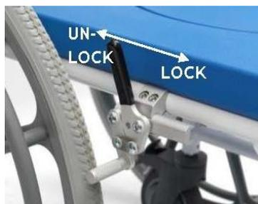
Poussez le levier du frein pour enclencher le freinage et procédez à l'opération inverse pour libérer les roues. Assurez-vous que les deux freins soient actionnés lorsque la chaise est à l'arrêt et lorsque l'utilisateur effectue un transfert latéral.
